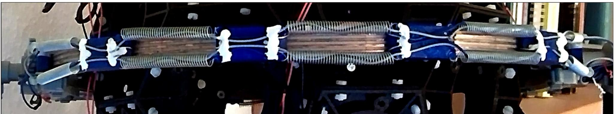
Die Schleifer werden über Spiralfedern mit den beiden Schlitten und untereinander verbunden. Als Kontakt dient versilberter Kupferdraht. Die Litze sind hier mit Heißkleber fixiert. Jede der vier Kupferleitungsbahnen hat somit mehrfach Kontakt, Unterbrechungen sind bisher ausgeblieben.
