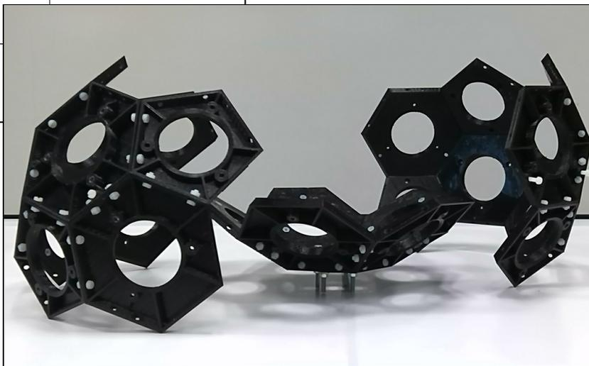
Die Bauteile werden mit Nylonschrauben verbunden (Gewichtersparnis)
