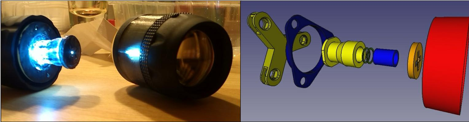
Sonnenprojektor: Kondensator ist die Laserlinse, Bild aus Alufolie mit Stecknadelloch. Objektiv: Taschenlampenkopf
