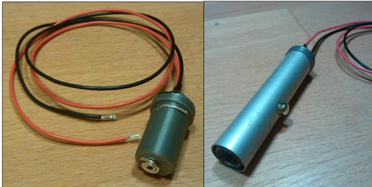
Laserprojektor: Extern Stromversorgung, Laserprojektor mit entfernter Linse, rechts: mit Bildhalter
